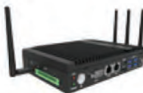
BXT-512 Промышл. мини-ПК x86 Core i3-7200U, 0~60 °C, 4 x RS232/485, 2 x Ethernet, HDMI, DP 4K
